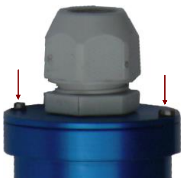
HyMADD-I: Oter les 2 vis avant d'enlever le couvercle
