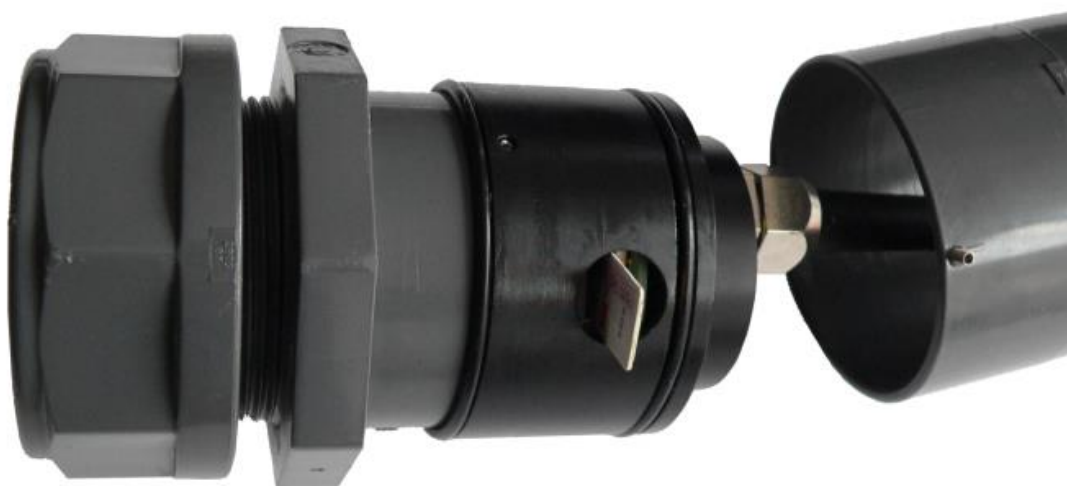
HyMADD-G: Loch, um die SIM-Karte zu installieren
