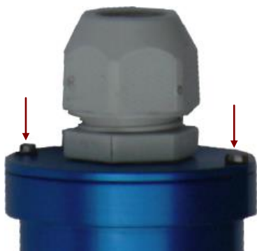
HyMADD-I: 2 Schrauben entfernen, Deckel abheben
